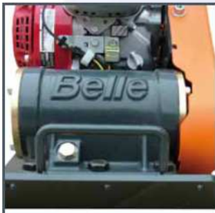
11kN vibration unit
